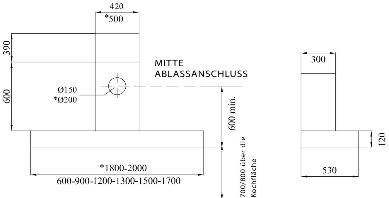
Die Abzugshaube nicht ein einem kleineren Anschluss als vorgesehen anschließen. Es besteht die Gefahr von Fehlfunktionen und Überhitzung des Motors. Wenn die Realisierung den Abluftanschluss  $\varnothing$  200mm (1200mc/h) nicht möglich ist, wie Standard vorgesehen (KP180-200), es wird empfohlen die Abzugshaube mit einem  $\varnothing$  150mm (900mc/h) Motor anzufordern.
